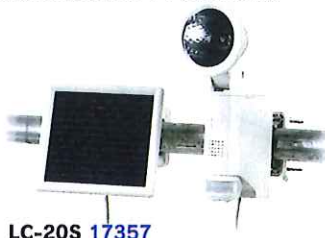
LC-20S 17357 (立体検知12m用) 検知方式:パッシブ 電圧・電力:DC6V (ハロゲン電球10W) 点灯時間:約5秒~30秒 配線接続:プラグ式5m
