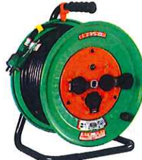
NW-E33 10855 VCT 2.0×3芯×30m 防雨・防塵型(屋外用) アース付
