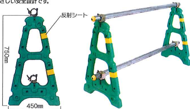
Aガード(反射シート付) 13959 (反射シートなし) 13960 高さ750×幅450×厚み70mm 約2.3kg HDPE(高分子ポリエチレン)
